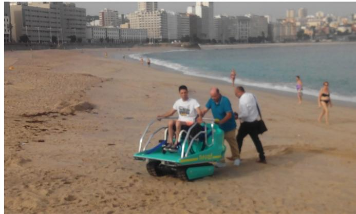
El vehículo se desplaza mediante un sistema de orugas. Esto genera una leve vibración sobre todo en los pavimentos más duros, asfaltados o con adoquines, y casi imperceptible en la arena, ya que es absorbida por ésta. Javier comentó que en los pavimentos duros se percibe ligeramente la vibración, pero que no es molesta, y que en la arena no se percibe ésta.
